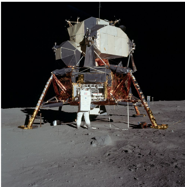
Спускаемый лунный модуль «Орел» космического корабля «Аполлон», разработка корпорации Грумман Аэроспэйс.
